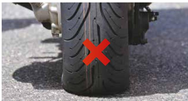
*QUANDO FIZER A INSPEÇÃO VISUAL, PRESTE BEM ATENÇÃO À BANDA DE RODAGEM E AO FLANCO (PAREDE LATERAL). PROCURE POR DESGASTES IRREGULARES, EXCESSIVOS OU INCOMUNS, OBJETOS ESTRANHOS, SALIÊNCIAS OU DEFORMAÇÕES, SINAIS DE PERFURAÇÃO, RACHADURAS NA BORRACHA OU QUALQUER DETERIORAÇÃO OU DANO.*
