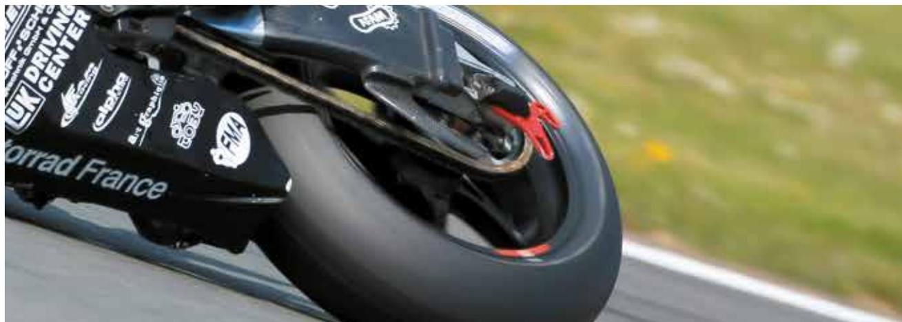
**SE O LIMITE LEGAL OU TÉCNICO DE DESGASTE FOI ATINGIDO EM UM PONTO DA BANDA DE RODAGEM, O PNEU DEVE SER SUBSTITUÍDO. O LIMITE LEGAL É AQUELE DETERMINADO PELA LEGISLAÇÃO DO PAÍS. O LIMITE TÉCNICO É DEMONSTRADO PELO INDICADOR DE DESGASTE (0.8 MM NOS PNEUS MICHELIN).**
